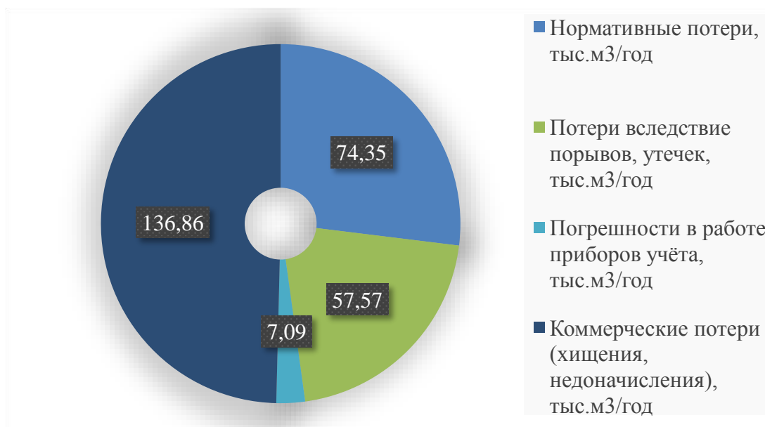
Рисунок 5 – Структурные составляющие потерь хозяйственно-питьевой воды при ее производстве и транспортировке
