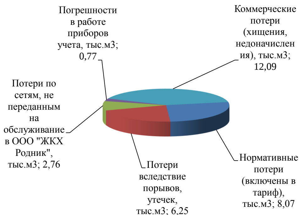
Рисунок 4 – Структурные составляющих потерь питьевой воды при ее производстве и транспортировке
