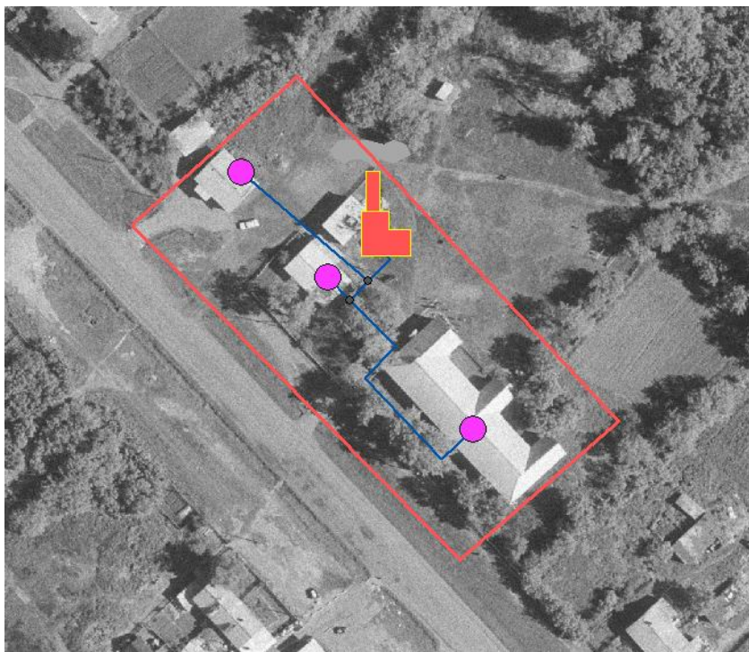
Рисунок 3.1 – Зона действия котельной №1
