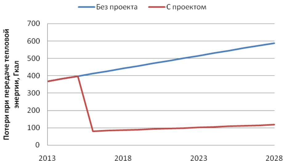
Рисунок 2.4 – Потери тепловой энергии при передаче по тепловым сетям п. Северо-Любинский
