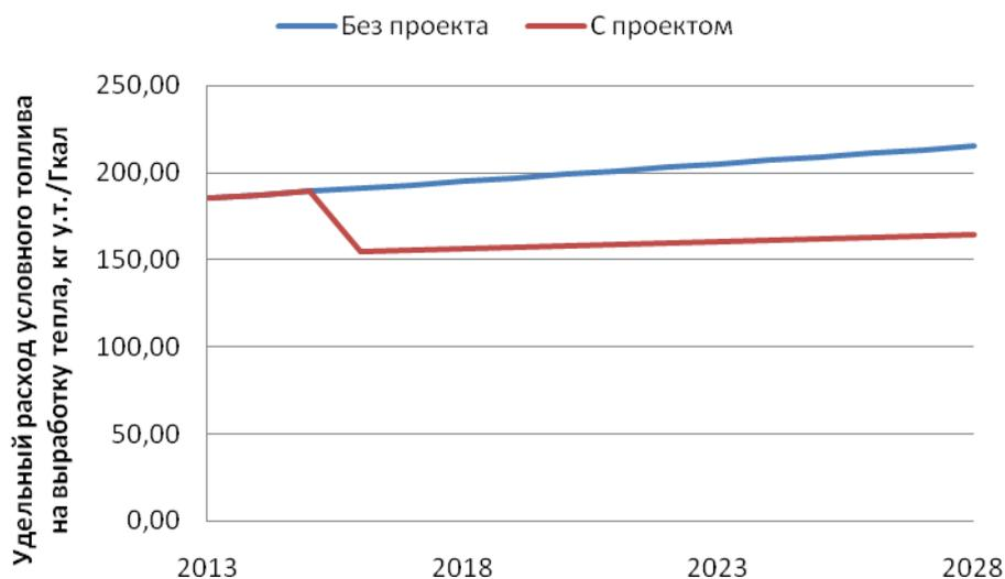
Рисунок 2.3 – Средневзвешенный удельный расход условного топлива на выработку тепловой энергии на источнике теплоснабжения п. Северо-Любинский
