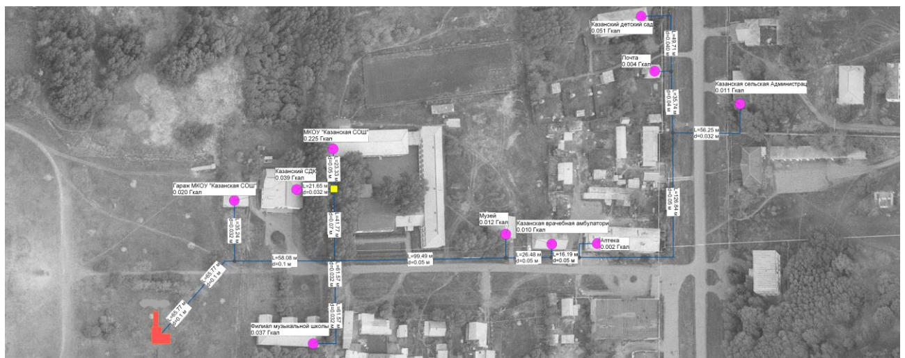
Рисунок 6.1 – Перспективная схема тепловой сети от котельной ООО «Сибирская земля» в с. Казанка
